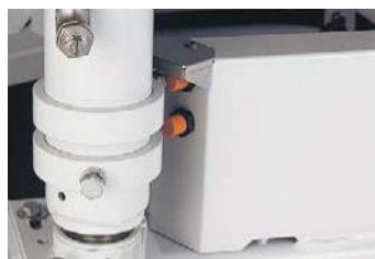
9 Бесконтактные датчики приближения контролируют положение щеток.
