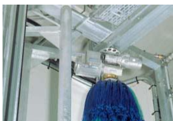
3 Коррозионностойкие корпуса из алюминия приводов вращения боковых щеток.
