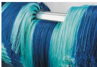
1 Боковые щетки и щетка крыши с легко заменяемыми щеточными сегментами.
