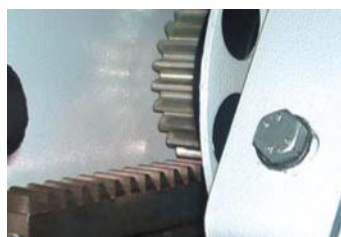
4 Зубчатая передача для нагруженных узлов перемещения боковых щеток.
