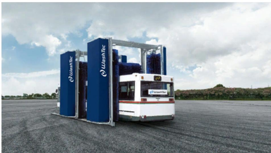
Двойной портал MaxiWash быстро обеспечит чистоту. Один портал моет переднюю часть транспортного средства, другой – заднюю часть. Мойка 12-метрового автобуса длится всего две с половиной минуты. MaxiWash Vario Tandem доступен в комплектации с четырьмя и шестью щетками.
