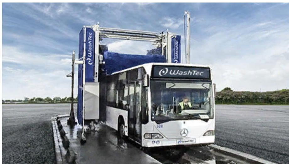
Часто возникает ситуация, когда необходимо поочередно помыть большое количество транспортных средств, а площадь для размещения коммерческой автомойки ограничена. Автомойка MaxiWash Vario сочетает в себе преимущества порталной и проездной мойки. Благодаря небольшой длине рельсов портал обеспечивает максимальные возможности независимо от длины транспортного средства, сокращая при этом даже время мойки.
