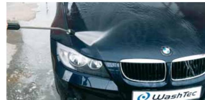
Расщепленная грязь смывается при помощи того же моечного пистолета, но при высоком давлении воды.
