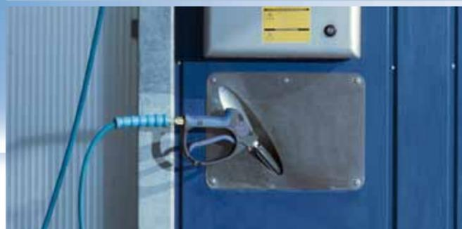
Отсеки для хранения моечного пистолета и щеток выполнены в современном стиле и объединены с металлическими конструкциями. Такая функциональность делает автомойку очень компактной.
