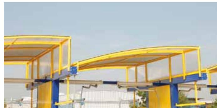
Потолочные поворотные консоли Z-образной формы для распылительной трубы и щетки вращаются на 360 градусов, таким образом, обеспечивая свободу перемещения внутри моющего бокса и защищая шланг от повреждений.
