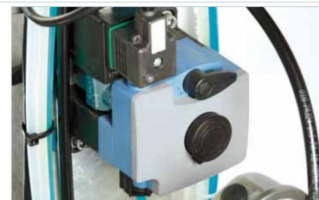
Дозирующие насосы моющих средств с гидравлическим приводом и частотным регулированием обеспечивают точную дозировку и снижение себестоимости мойки, обеспечивая при этом наилучший моечный результат.
