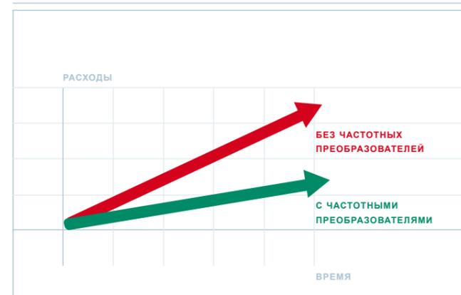
Применение частотных преобразователей для двигателей насосов высокого давления позволяет менять скорость их вращения, устанавливать рабочие давления и расход воды для каждой моечной операции.
