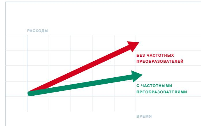
Применение частотных преобразователей для двигателей насосов высокого давления позволяет менять скорость их вращения, устанавливать рабочие давления и расход воды для каждой моющей операции.
