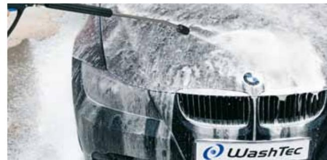
Нанесение толстого слоя пены при низком давлении расщепляет грязь.
