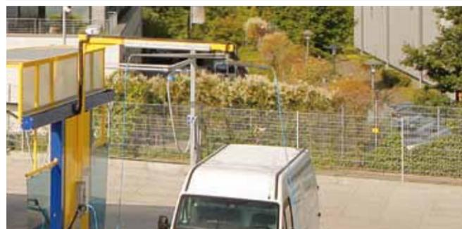
Наличие кронштейна на открытом моечном посту обеспечивает рабочую зону до 10 метров и делает комфортнее мойку трейлеров, транспортеров и других больших транспортных средств. Удлиненные щетки и моечные пистолеты делают процесс мойки автомобиля.
