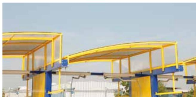
Потолочные поворотные консоли Z-образной формы для распылительной трубки и щетки вращаются на 360 градусов, таким образом, обеспечивая свободу перемещения внутри моечного бокса и защищая шланг от повреждений.
