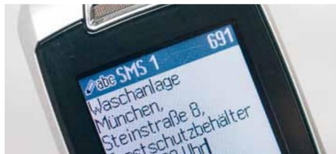
В случае сбоя технология передачи данных отправляет сообщения через модем. Таким образом, можно оперативно выявить и устранить неисправность.
