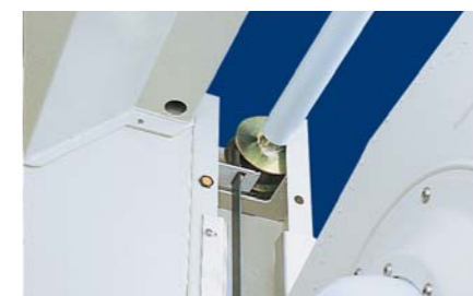
↑ Использование необслуживаемых, плоских армированных ремней для подъема устройств позволяет избежать смазочных и профилактических работ.
