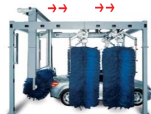
↑ Вертикальные щетки перемещаются вдоль автомобиля по направлению движения; горизонтальная щетка движется вслед за автомобилем.
