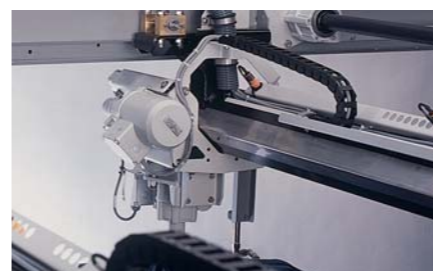
↑ Кронштейны для перемещения боковых щеток выполнены из высококачественной нержавеющей стали.
