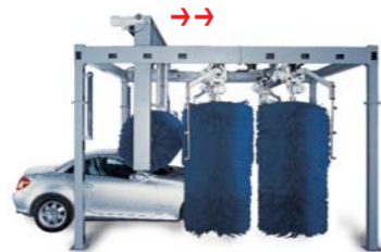
↑ Горизонтальная щетка перемещается вдоль автомобиля по направлению движения
