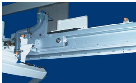
↑ Вертикальные и горизонтальные щетки перемещаются вдоль движения автомобиля на 850 мм. При этом скорость движения конвейера не должна превышать 11 м в минуту
